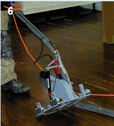
**1.** Mittels verstellbarem Klemmhebel kann über einen Exzenteranschlag die Eintauchtiefe der Säge stufenlos eingestellt werden.
