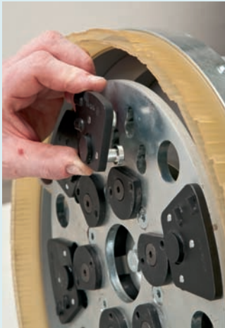
Schnellwechsel der Werkzeugsegmente
