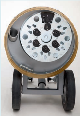
Die völlig neu konzipierte Absaughaube ist beweglich gelagert und mit doppelter, flexibler Staubschutzlamelle für sichere Staubabdichtung versehen.
