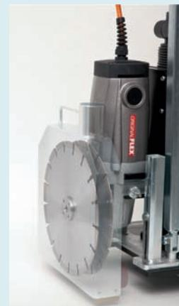
Um Schlitze zu schneiden, können zwei Trennscheiben im Abstand bis zu 30 mm montiert werden
