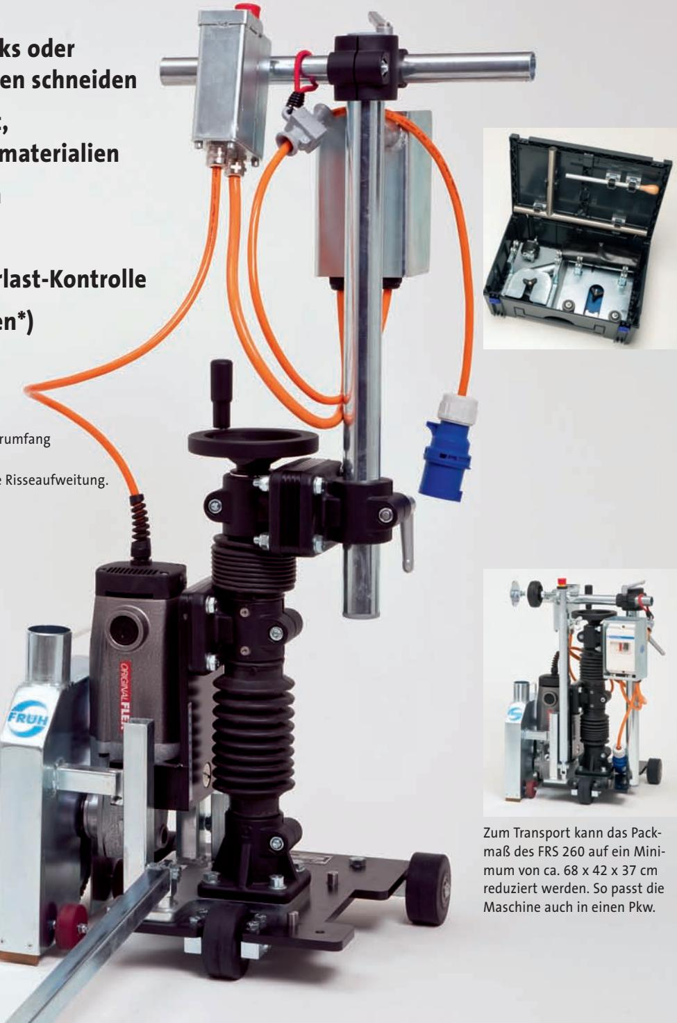
Zum Transport kann das Packmaß des FRS 260 auf ein Minimum von ca. 68 x 42 x 37 cm reduziert werden. So passt die Maschine auch in einen Pkw.
