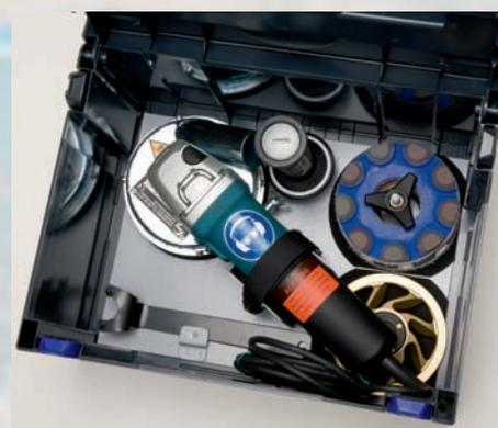
■ Maschine mit Trägerteller, Bedienwerkzeug, komplett im Transportsystainer.
