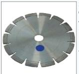
1. DIAMANT Trennblatt abrasiv spezial Ø 150 mm Art.Nr. 232.304 10 mm Segmenthöhe, Bohrung 22,23 mm, mit Kernschutzsegment für Kunstharzmörtel, Estriche und Beläge
